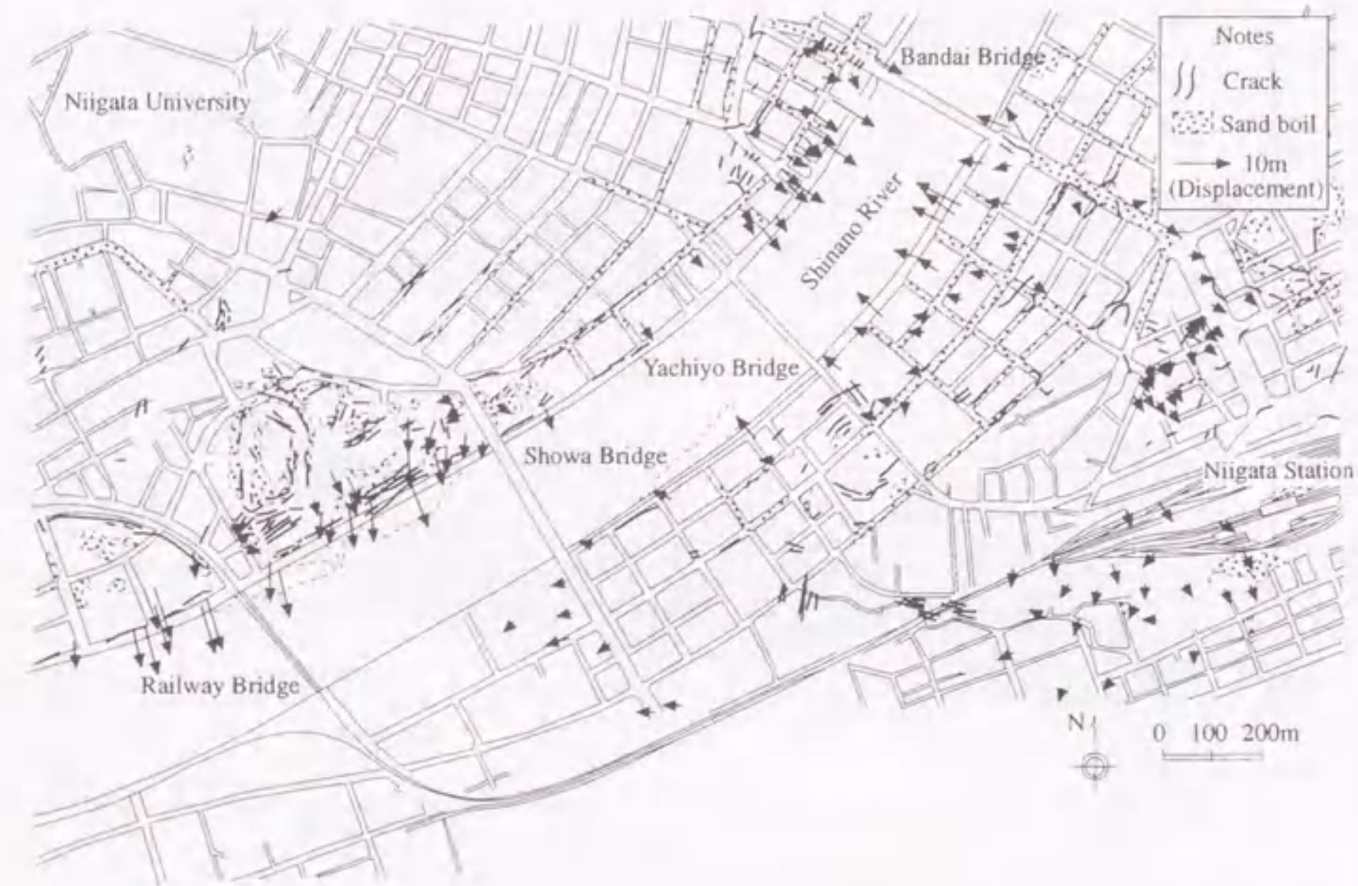
図2.2 1964年新潟地震での地盤変状図 (浜田ら (1986a) を一部修正)
