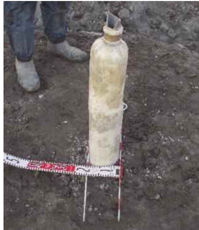
写真-4.17 掘削した地山パッカ
