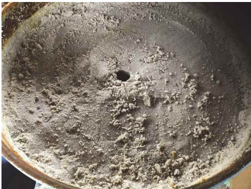
写真-5.3 小型動的コーン貫入試験の試験孔
