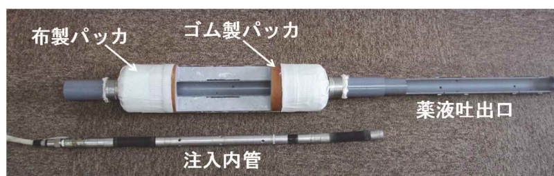
写真-3.1 新工法の地山パッカの構造（模型）
