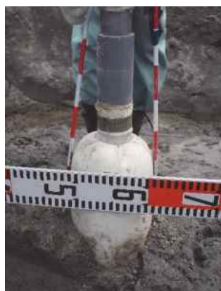
写真-4.12 掘削した地山パッカ（φ120mm）
