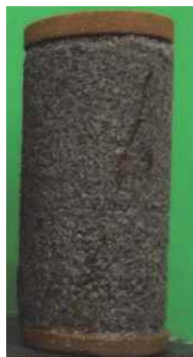
写真-4.21(a) 試験後供試体 (Type A G.L.-2m～-3m)
