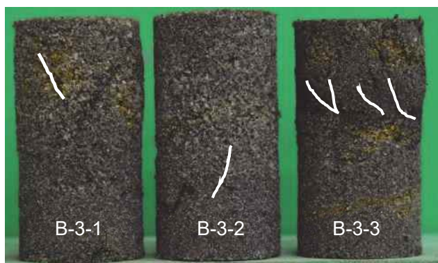
写真-4.16 一軸圧縮試験後の供試体
