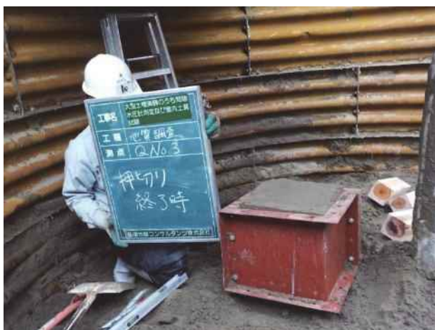
写真-4.9 ブロックサンプリングモールド
