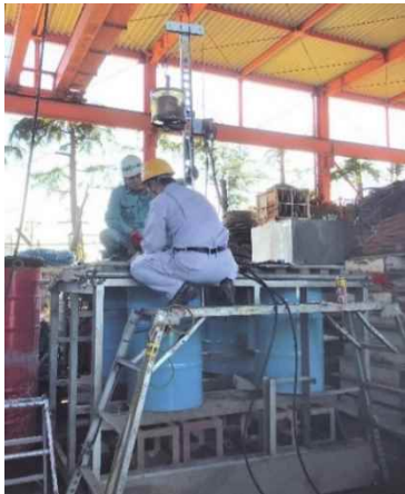
写真-5.2 小型動的コーン貫入試験
