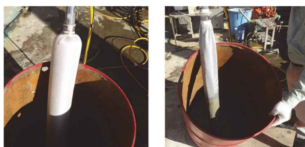
写真-3.2 地山パッカの拡大状況（左：新パッカ、右：従来パッカ）
