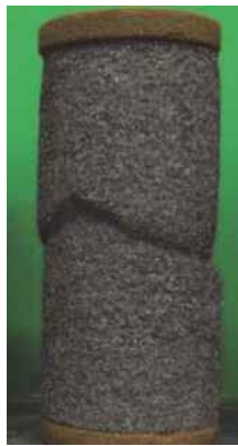
写真-4.21(b) 試験後供試体 (Type A G.L.-2m～-3m)
