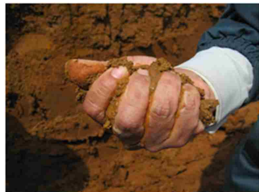
図-4.25 崩壊土の含水状態 13)
