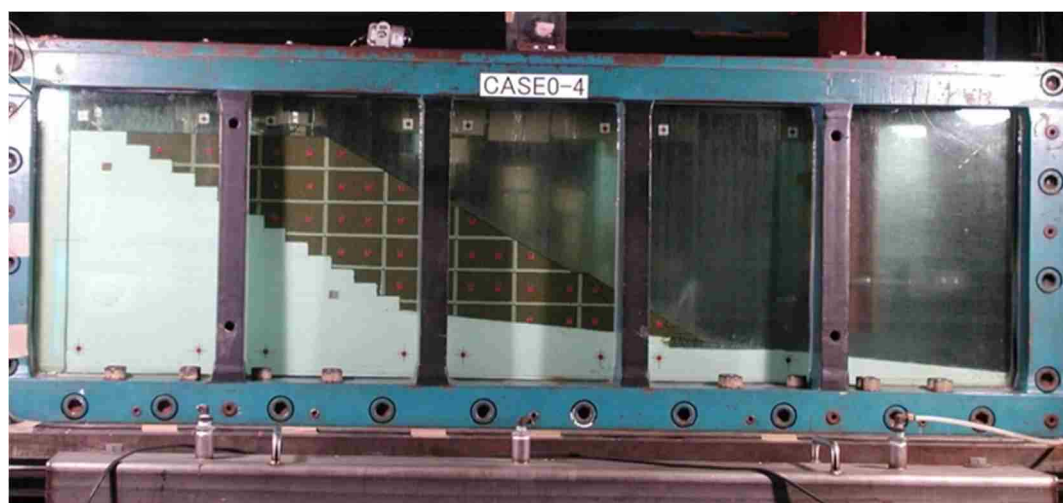
図-6.13 遠心力载荷模型写真（無対策）
