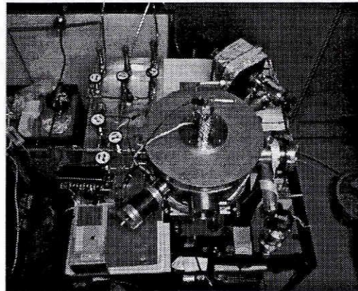
(B) 上部から見た nc-GaN 薄膜作製用スパッタリング装置
