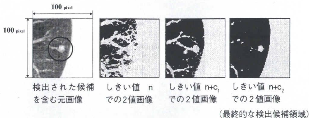
図4.10 しきい値による検出候補領域の変化. 円の中心付近が検出された候補 (TP). n, c_1, c_2 は整数 ( c_1 < c_2 ).
