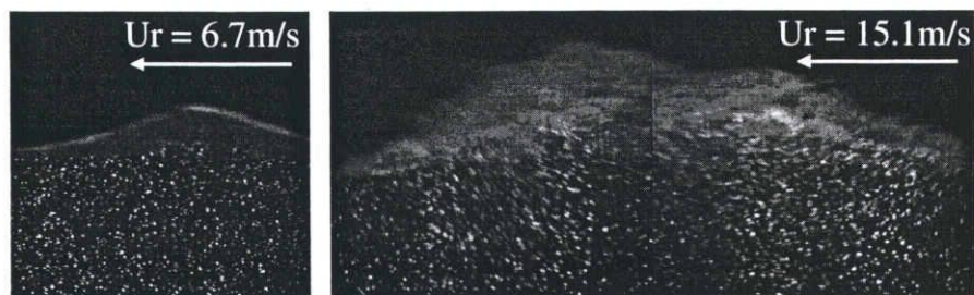
図 5.3 風速 U_r = 6.7 および 15.1 m/s における波面表層の可視化画像
