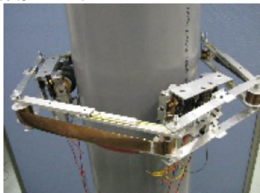
図 25 垂直昇降移動機構
