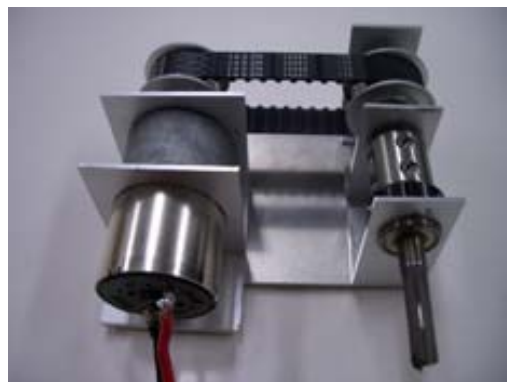
図28 ルーター刃による切断機構
