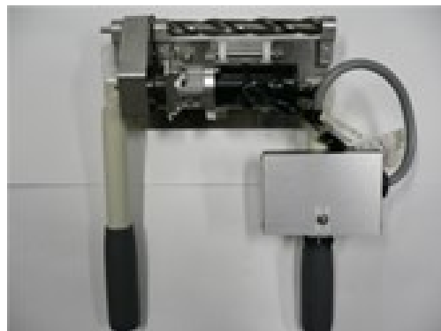
図27 エンドミルによる切断機構
