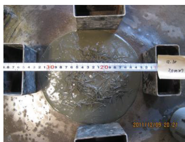
写真 - 4.2 材料分離状況
