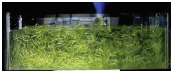
図-5.9 移動打込みの場合の PVA 繊維 (0.5%) の配向
