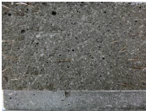
図 - 8.11 コンクリートの合流部の破断面
