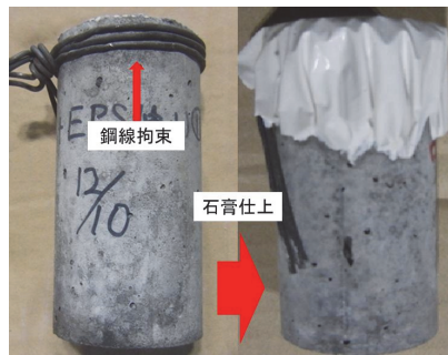
写真 4-3 鋼線拘束石膏仕上げ
