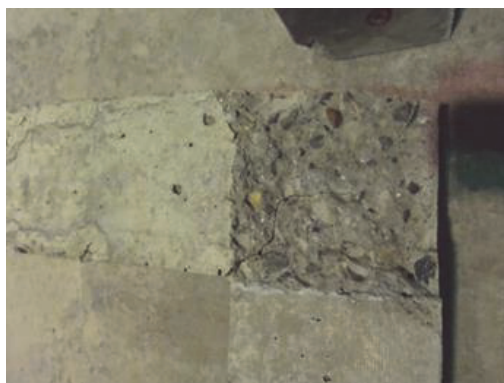
写真 5-10 三本足供試体①破壊性状
