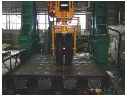
写真 3-10 輪荷重走行試験機
