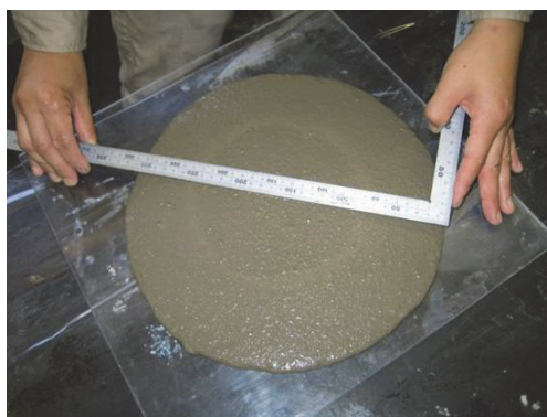
写真 3-7 フレッシュ性状（モルタルフロー 310mm 程度）
