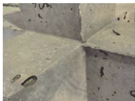
写真 5-14 HPFRCC+EPS 有筋の破壊性状
