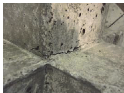
写真 5-12 NC 有筋の破壊性状
