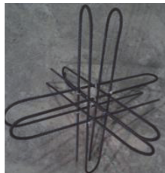
写真 5-6 内部鉄筋形状
