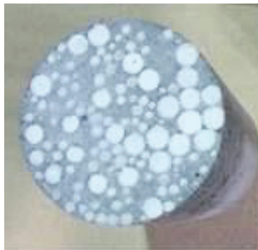
写真 4-1 EPS を混入した圧縮供試体断面
