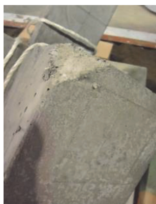
写真 5-13 HPFRCC+EPS の角つぶれ
