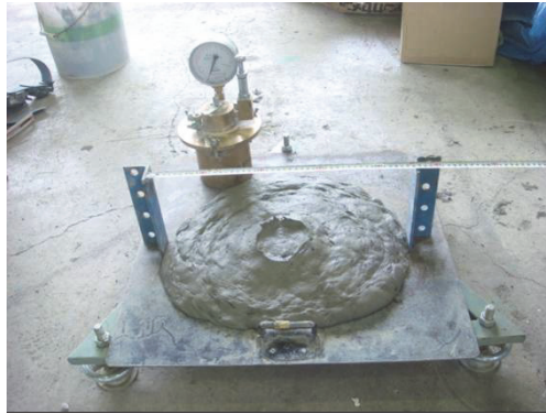
写真 3-9 品質管理試験状況（スランプフロー）
