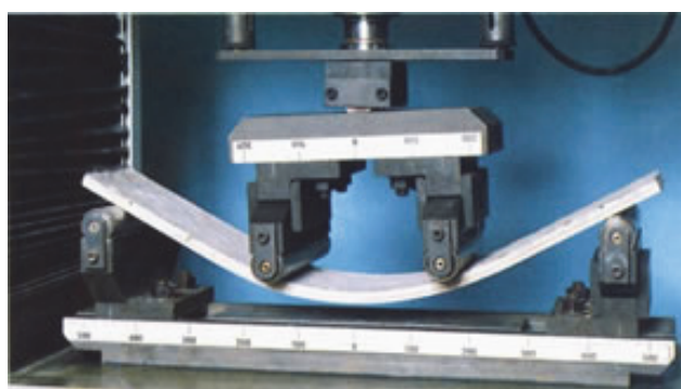
写真 1-1 HPFRCC の曲げ変形性能
