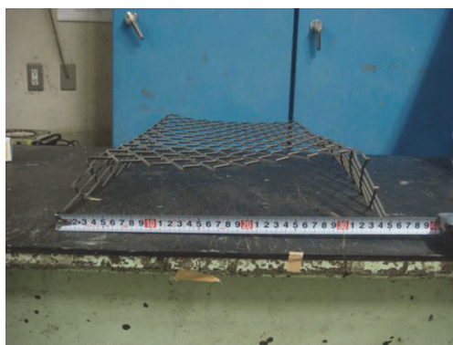
写真 3-6 エキスパンドメタルの加工状況
