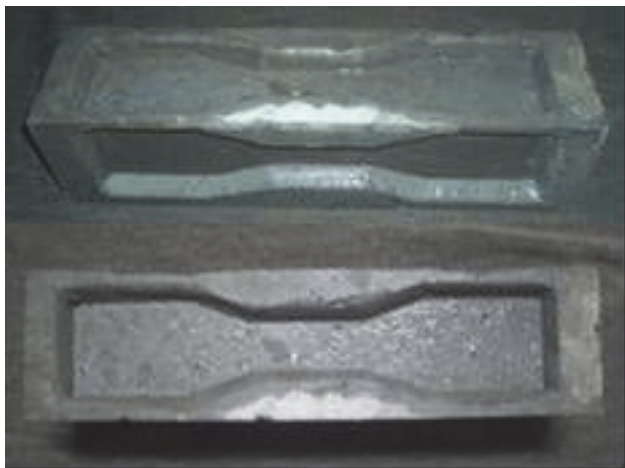
写真-4.13 はめ込み型枠
