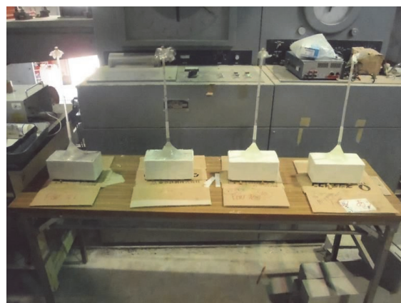
写真-6.2 透水試験の試験風景
