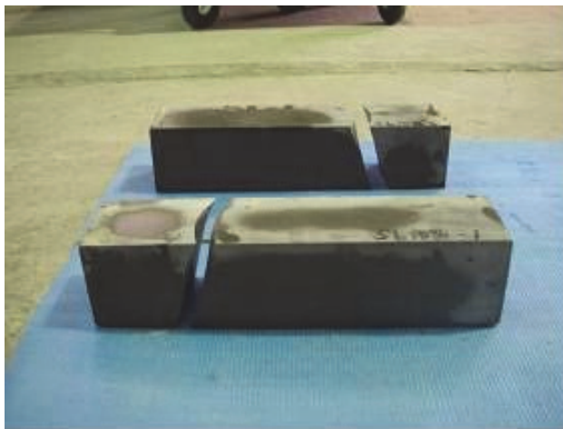
写真-4.5 凍結融解試験 30 サイクルで破壊した SL 供試体
