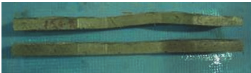
写真-4.15 凍結融解試験後のダンベル型供試体（上：曲がった供試体、下：通常の供試体）
