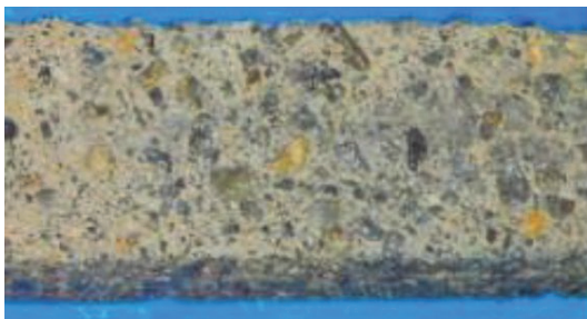
写真-1.10 凍結融解作用終了後の複合劣化供試体
