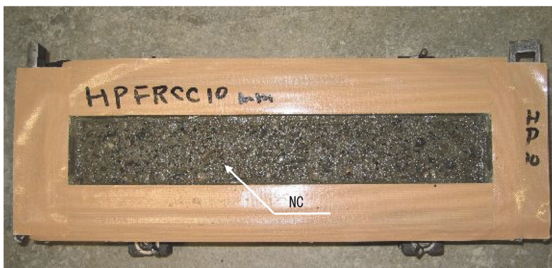
写真-2.2 表面処理状況
