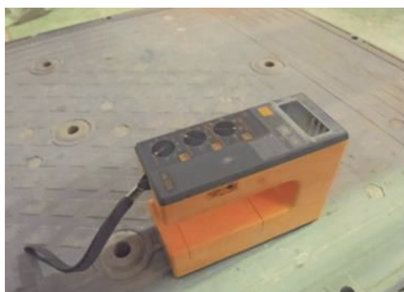
写真-6.1 コンクリート・モルタル水分計
