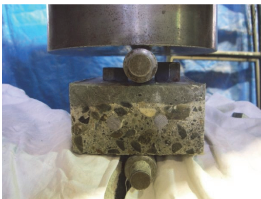
写真-3.2 供試体割裂
