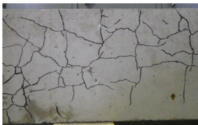
写真－6.12 試験 No. 3 供試体（ASR 反応性骨材を使用した ASR ひび割れ供試体）
