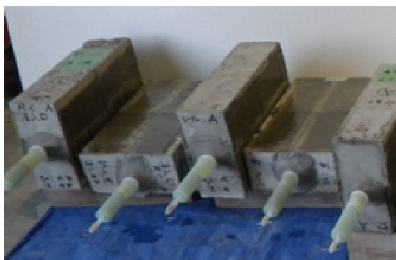
写真-5.4 注入時のブロック供試体
