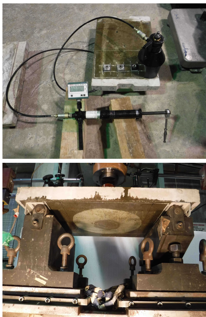
写真-4.1 付着試験状況（上） 押抜き試験状況（下）
