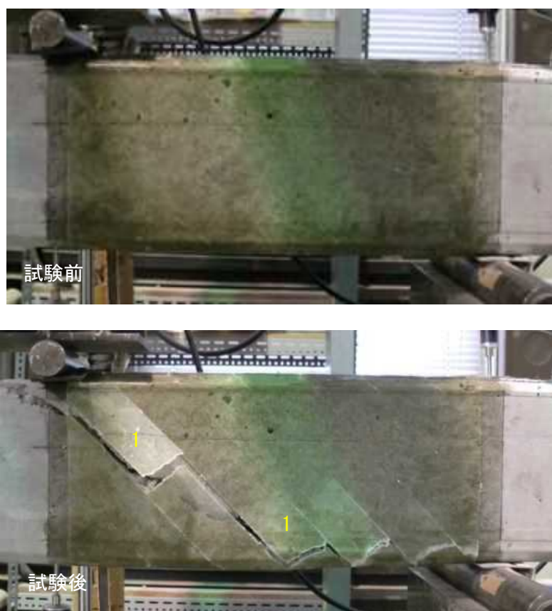
写真-3.7 No. 6 (100%135 度) せん断破壊状況
