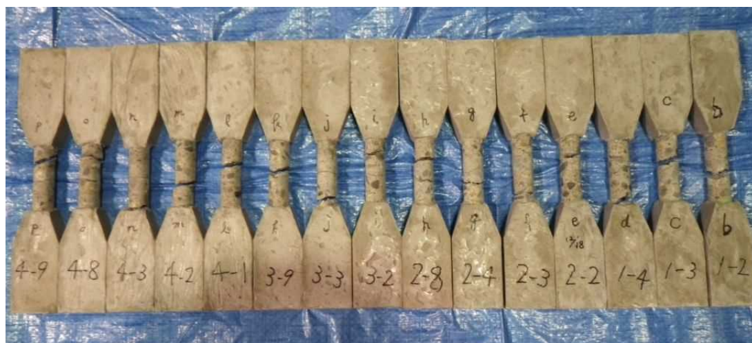
写真－5.8 引張供試体の破壊状況(右側より No. 1)
