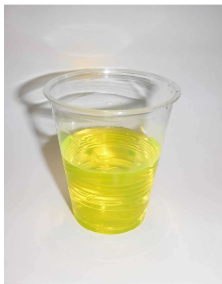
写真－4.3 生分解性蛍光トレーサー染料による着色水
