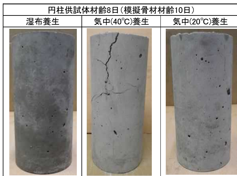
写真-6.7 模擬骨材 B 置換率 10%供試
