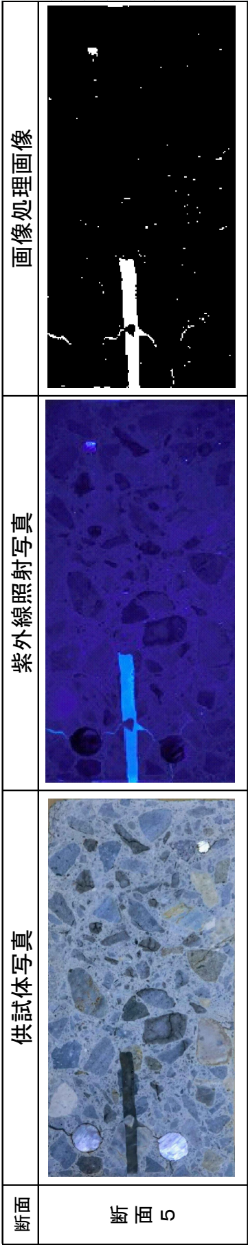
図一6.8 試験No.3 ASR 反応性骨材使用供試体（縦断面）
