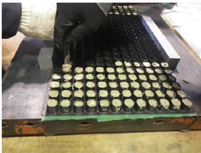
写真-6.4 模擬膨張骨材打設状況
