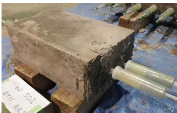
試験 No. 2 供試体（模擬膨張骨材使用供試体） （試験 No. 1 供試体も同様な状況）
