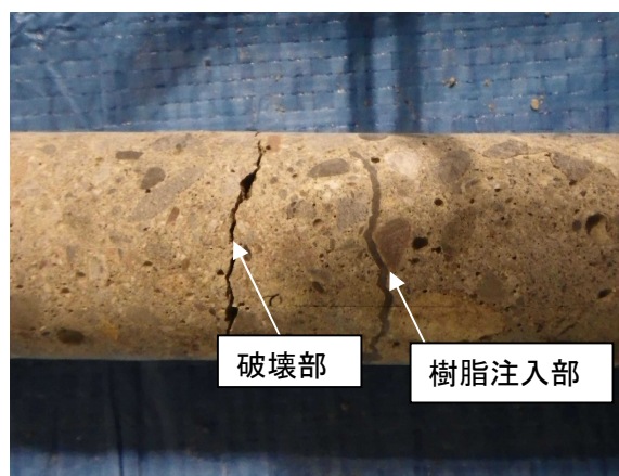
写真－5.12 25mm コア引張供試体の破壊状況(一例)
