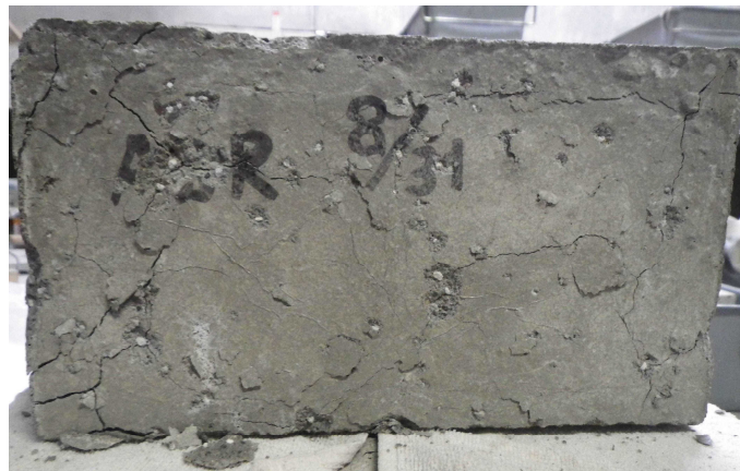
写真－6.10 試験 No. 1 供試体（静的破砕剤使用時供試体）
