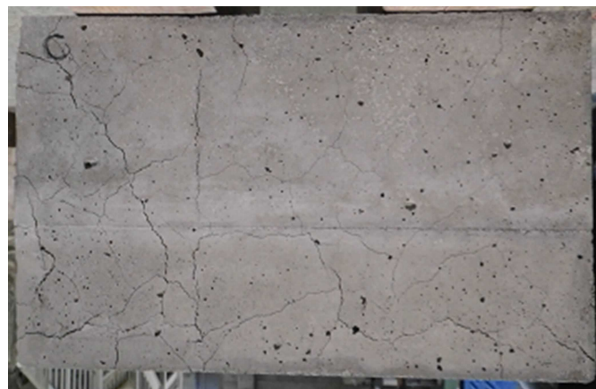
写真－6.11 試験 No. 2 供試体（模擬膨張骨材使用時供試体）
