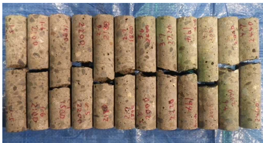
写真-5.11 50mm コア曲げ供試体の破壊状況 (全体)
