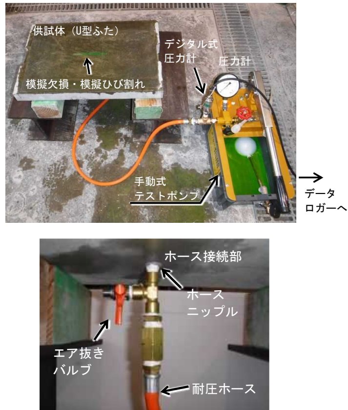
写真－4.2 試験全体写真（上） 背面ホース接続部（下）
