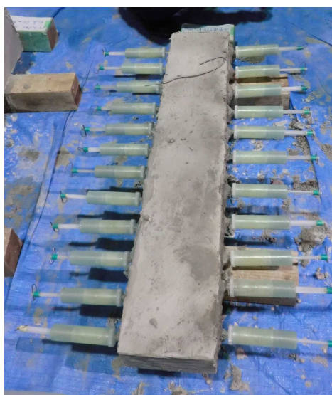
試験 No. 3 供試体 （ASR 反応性骨材使用供試体）
