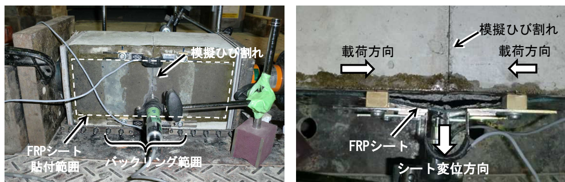
写真-2.6 FRP シートのバックリング
