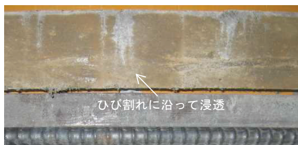
<暴露 1 年後, UHP-SHCC 被覆厚 50mm, 最大曲げ引張ひずみ 1.51%>
