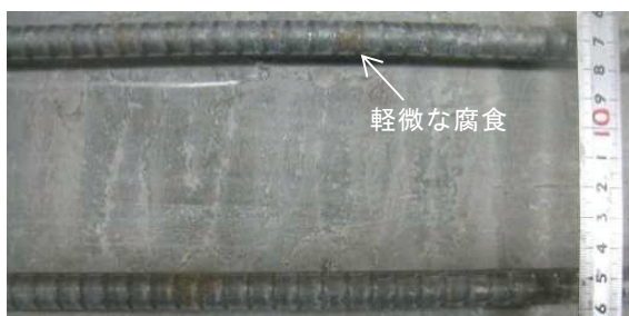
<暴露 1 年後, UHP-SHCC 被覆厚 30mm, 最大曲げ引張ひずみ 1.51%>
