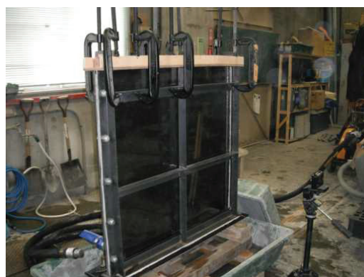
図-8.2 模擬型枠構造
