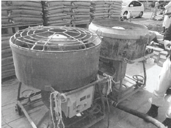
現場製造状況（パン型強制練りミキサ）
