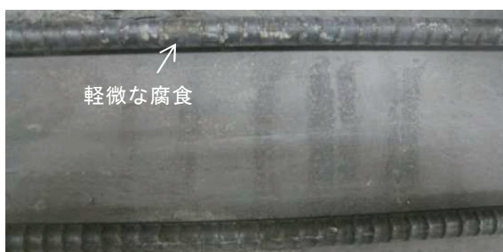
<暴露 1 年後, UHP-SHCC 被覆厚 30mm, 最大曲げ引張ひずみ 0.57%>
