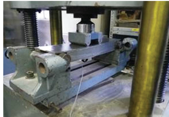
図-3.3 曲げ荷荷によるひび割れ導入方法
