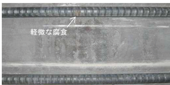
<暴露 1 年後, UHP-SHCC 被覆厚 50mm, 最大曲げ引張ひずみ 1.51%>
