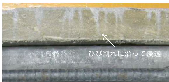
<暴露 1 年後, UHP-SHCC 被覆厚 30mm, 最大曲げ引張ひずみ 1.51%>
