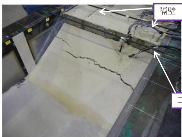
写真 3-2-6 加振後ののり面の状況
