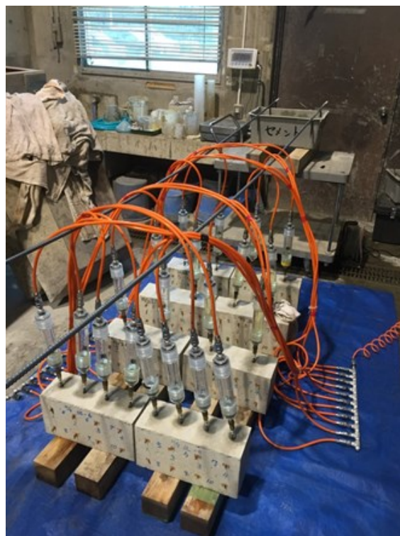
写真-4.3 リチウム圧入の様子
