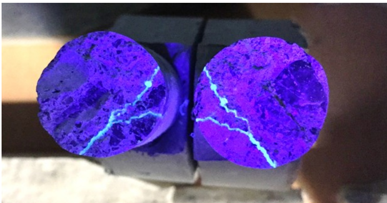
写真-6.11 注入あり模擬 ASR 供試体断面
