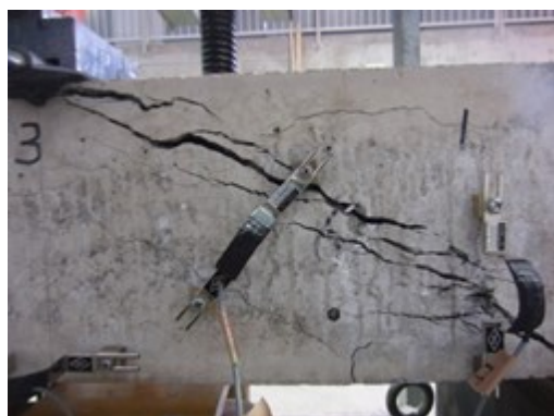
写真-5.6 破壊性状 (1100mm 補修フックあり 2-3)
