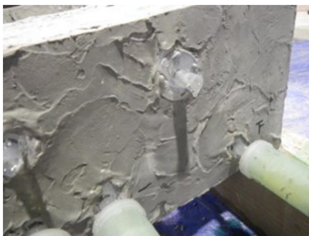
写真-6.12 樹脂注入時の注入口様子
