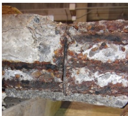
写真-5.5 載荷後φ3 フックなし B-2 供試体支点部付近
