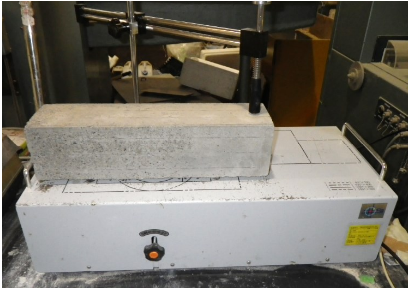
写真-3.7 一次たわみ振動数測定機
