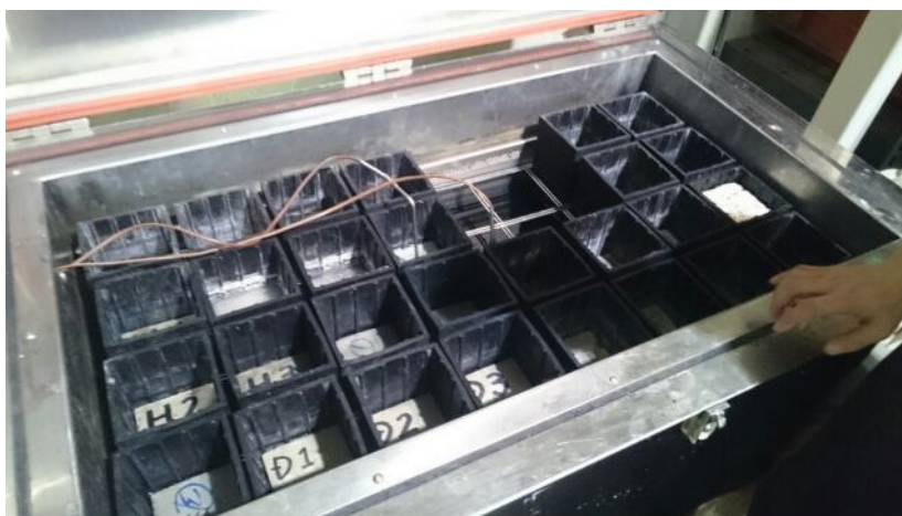
写真-3.6 凍結融解試験機
