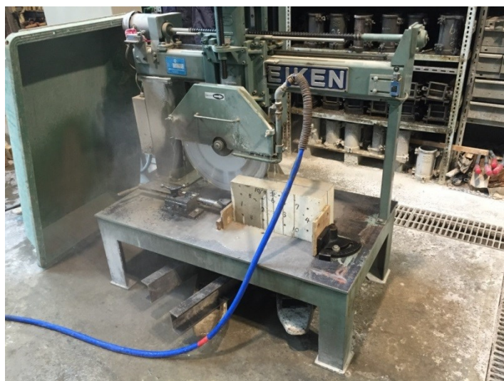
写真-4.5 供試体切断の様子
