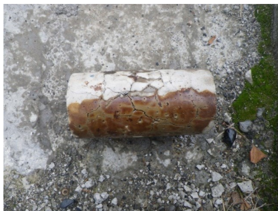
写真-4.7 呈色試験による変色例
