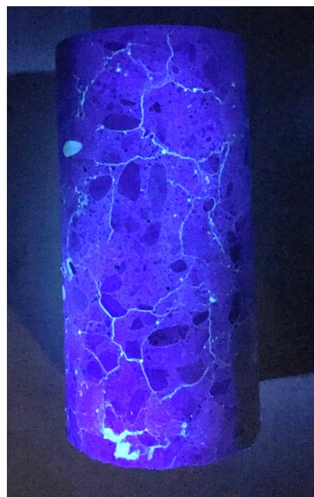
写真-6.14 模擬 ASR コア供試体
