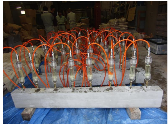
(d) リチウム加圧注入
