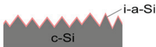
図 4.1 a-Si/c-Si 界面特性を得るための試料の構造
