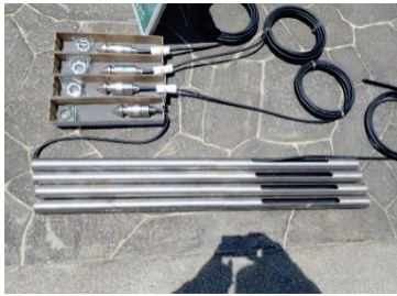
写真 5.4 地中間隙水圧計
