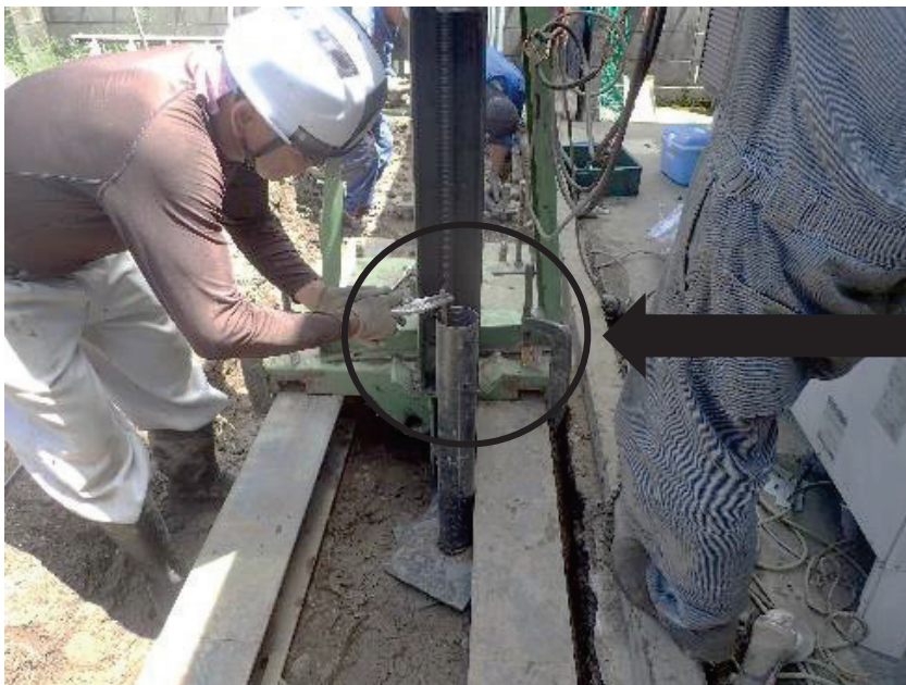
写真 A. 3. 14 鋼棒を捨てビットに固定する様子
