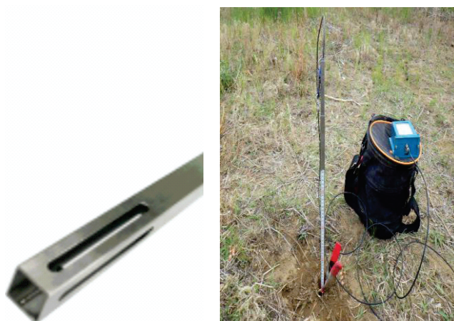
写真 4.4 地下水位検出装置(左)および調査状況(右)
