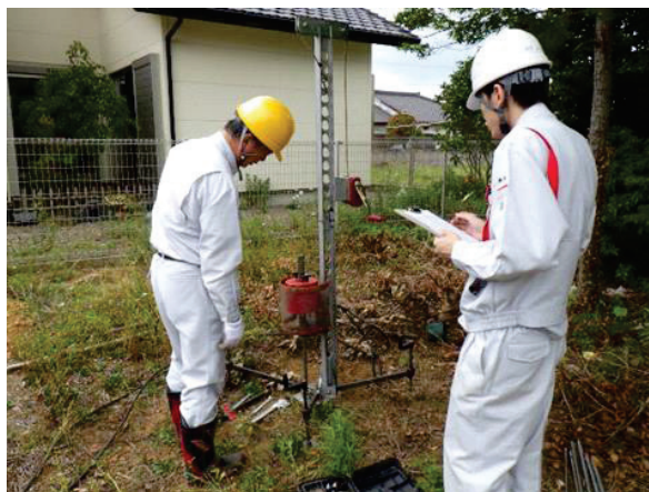
写真 4.2 PENNY による地盤調査状況
