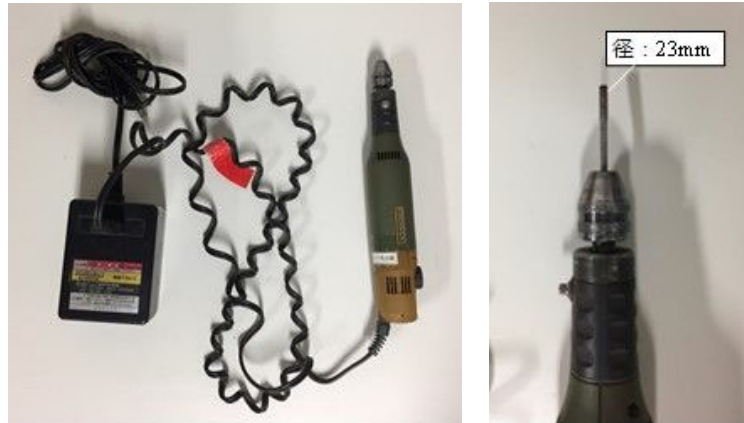
写真 3-12 さびの採取に用いた電動ルーター
