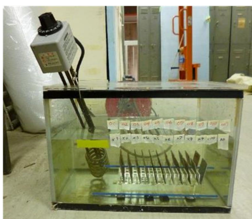
写真 2-5 さび除去の状況
