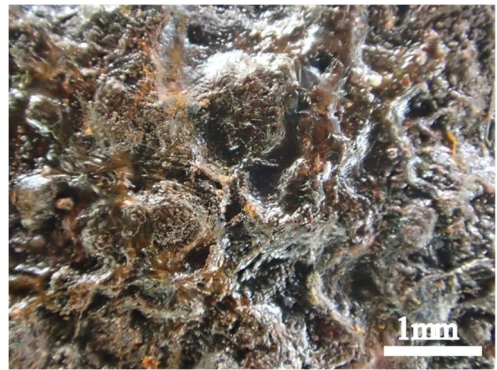
(d) 9:1 試験体局部腐食箇所
