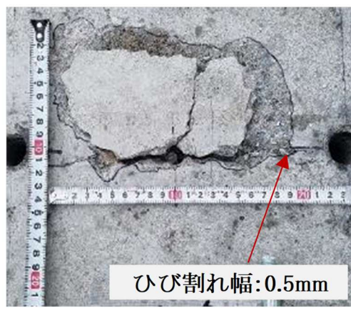
図-2.32 金属系芯棒打込式の破壊状況 (PIPE 式)
