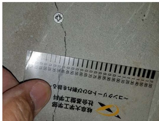
図-3.9 ひび割れ幅計測状況（PIPE 式）
