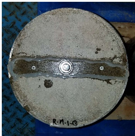
図-3.12 補修材硬化完了
