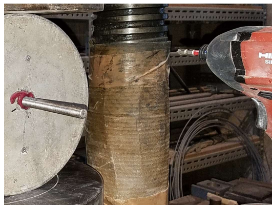
図-3.8 ひび割れ導入および保持状況（PIPE 式）
