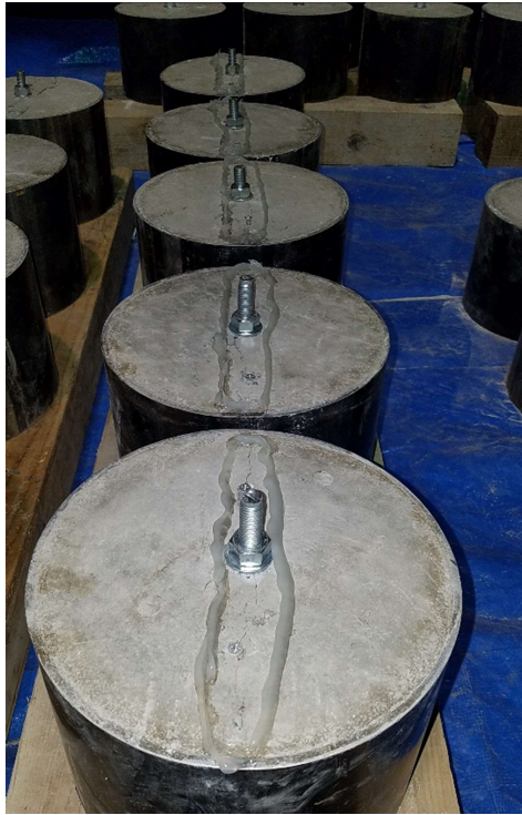
図-3.10 補修部シール状況
