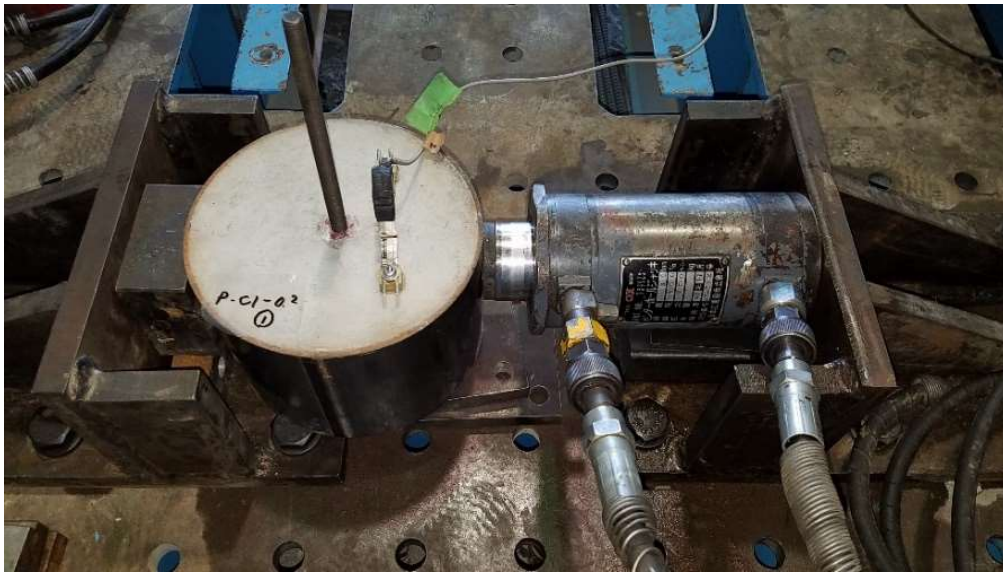
図-2.20 引抜き試験前ひび割れ幅調整状況 (PIPE 式)
