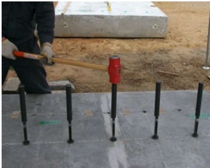
図 2.6 ひび割れ発生状況(ETAG 式)
