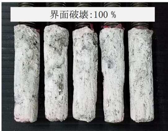
図-2.33 注入式の破壊状況(ETAG 式)
