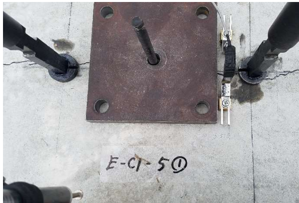
図-2.12 接着系アンカー引抜き試験状況(拘束試験)
