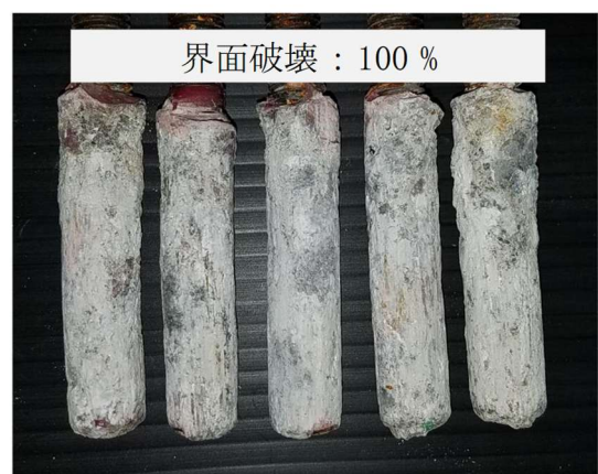
図-2.34 注入式の破壊状況(PIPE 式)
