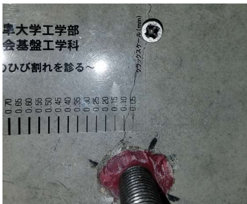
図-3.9 ひび割れ幅計測状況（PIPE 式）
