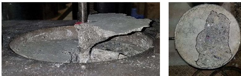
図-3.23 ひび割れ幅 0.3mm のコーン状破壊 (接着系注入式)
