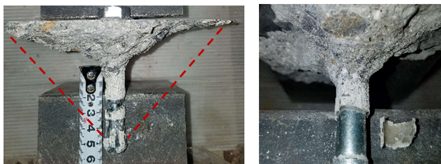
図-3.19 ひび割れ注入材の付着状況(金属系)
