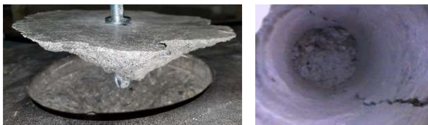
図-3.17 ひび割れがない場合のコーン状破壊と孔底の状況(金属系)
