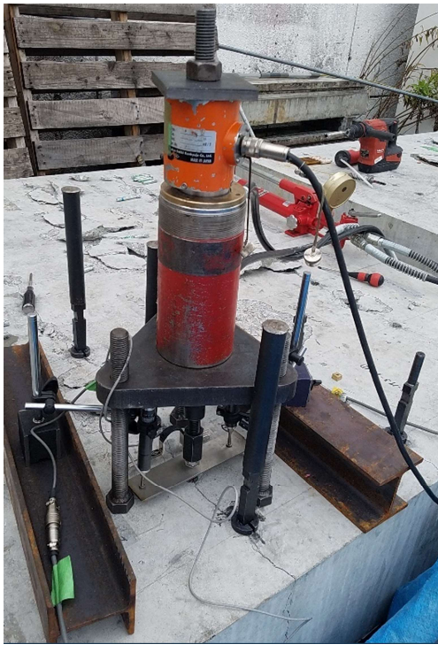
図-2.11 金属系アンカー引抜き試験状況(非拘束試験)
