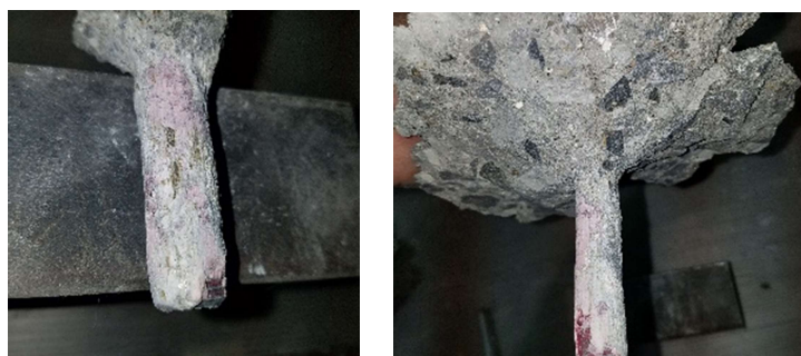
図-3.25 ひび割れ注入材の付着状況 (接着系注入式)
