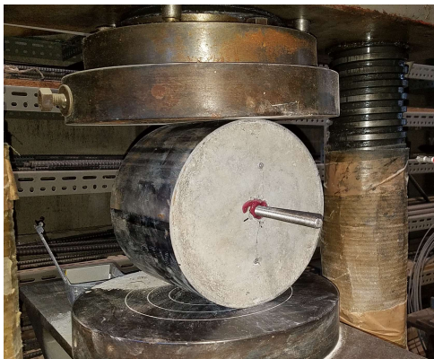
図-3.8 ひび割れ導入および保持状況（PIPE 式）
