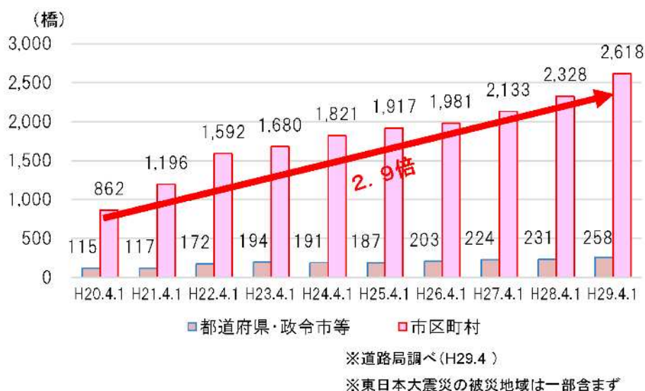
図-1.2 地方公共団体管理橋梁の通行規制等の推移(2m以上)【1.1】
