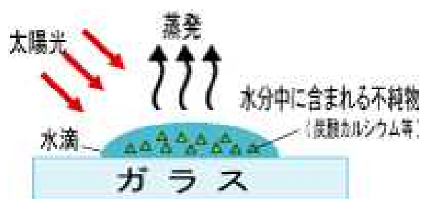
Fig.1-3 水滴から生じる水垢形成の模式図
