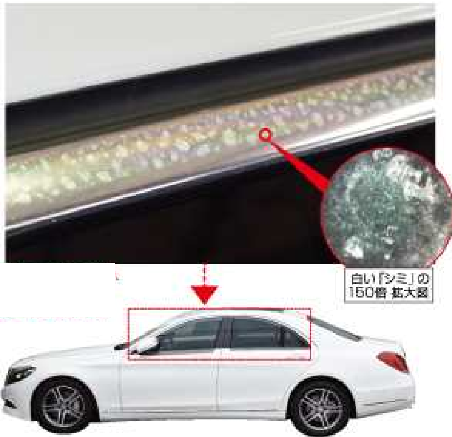
Fig.1-5 メッキモールの劣化状況
