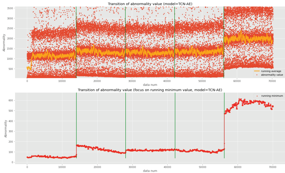
図 6.19 TCN-AE による異常度算出結果 (データセット 2)
