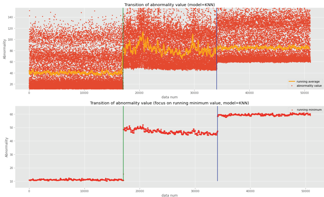
図 6.4 K-NN による異常度算出結果 (データセット 1)
