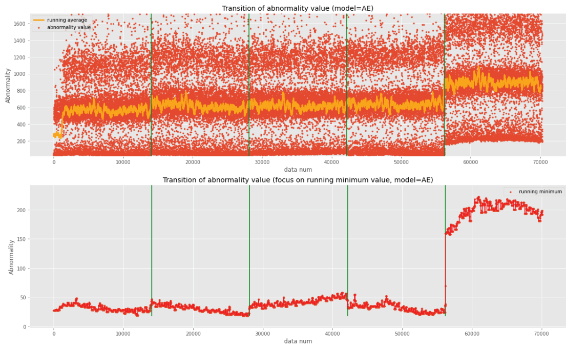
図 6.18 FFNN-AE による異常度算出結果 (データセット 2)
