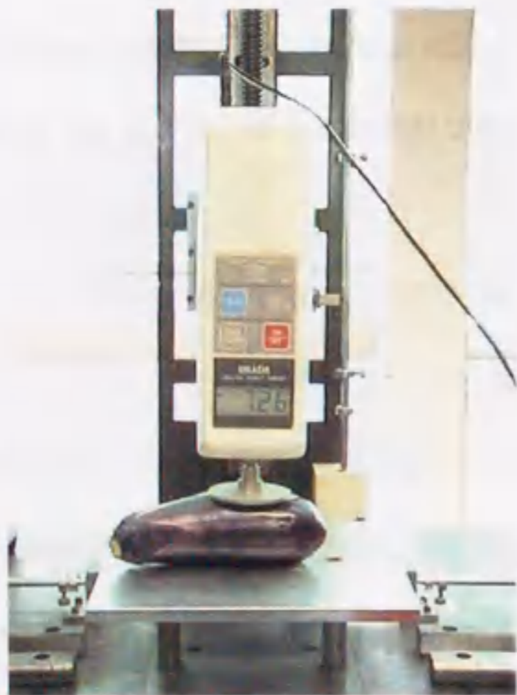
Fig.2-7 Compression test devise for eggplants 図 2-7 ナスの圧縮試験装置
