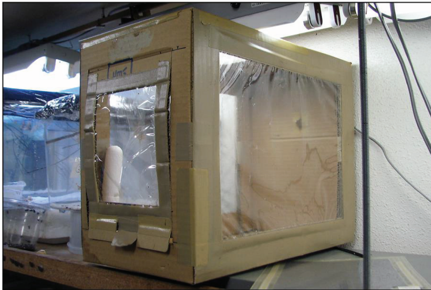
図15. 室内飼育に用いた飼育箱. 段ボール箱に明るさと視認性を高めるためにフィルムを貼った。
