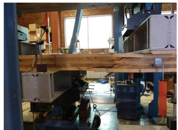
Fig. 4.2.7 厚さ 120mm 5層 ラミナ混合配置 破壊状況
