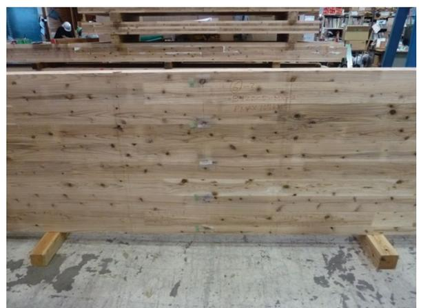
Fig. 3.3.17 厚さ 120mm 5層 ラミナ混合配置 引張側破壊状況
