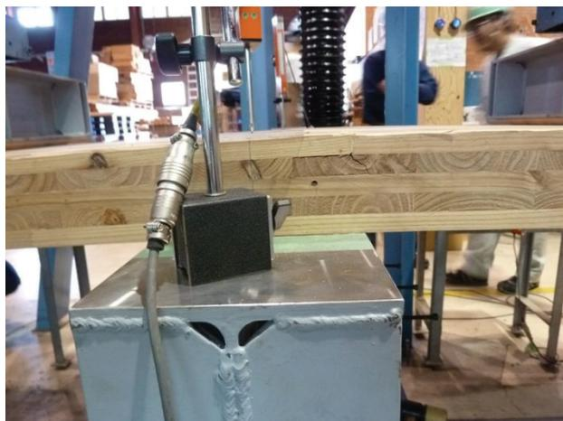
Fig. 4.2.10 厚さ 90mm 5層 ラミナ混合配置 破壊状況
