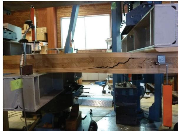
Fig. 4.2.6 厚さ 120mm 4層 ラミナ混合配置 破壊状況
