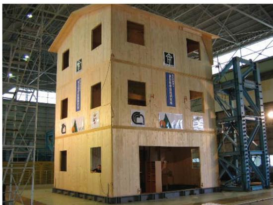
Fig. 1.2.2 SOFIE project 3 階建振動実験 (筆者撮影)
