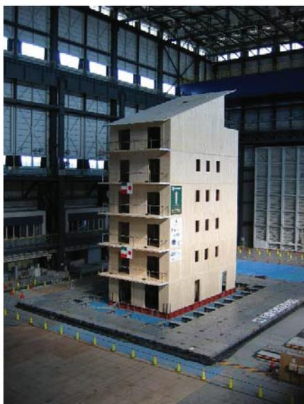
Fig. 1.2.3 SOFIE project 7 階建振動実験 (筆者撮影)
