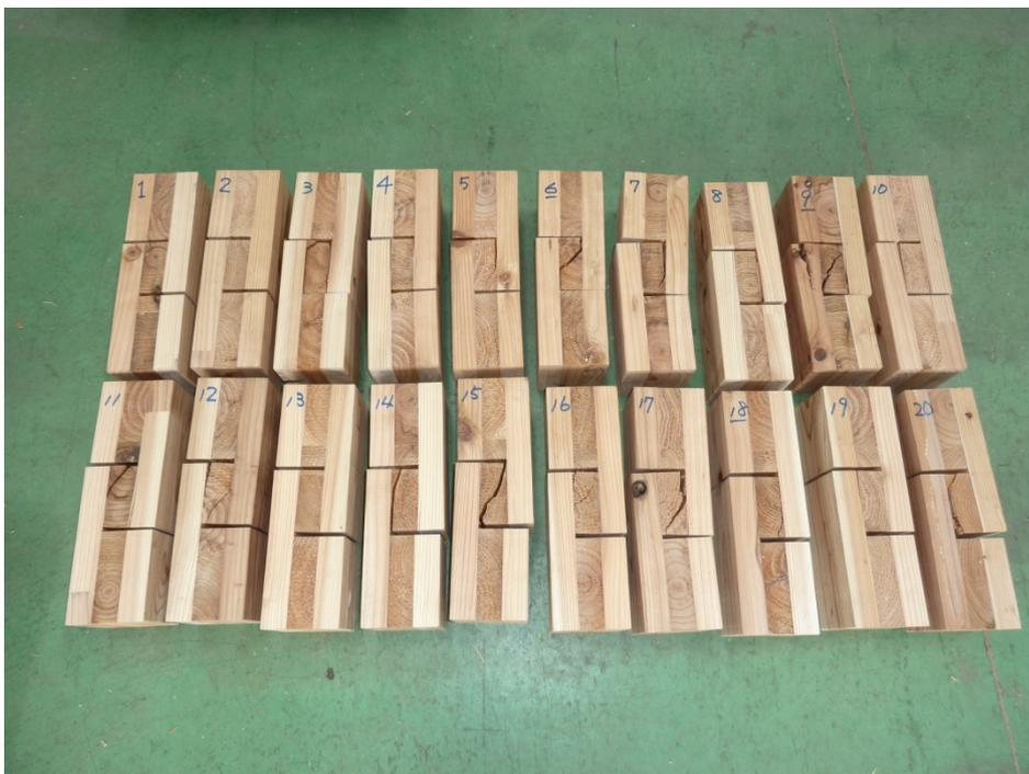
Fig. 4.1.9 ローリングシアー 試験体破壊状況
