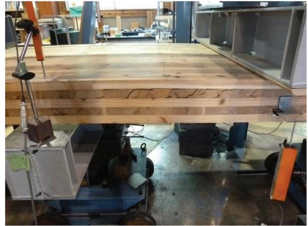
Fig. 4.2.5 厚さ 150mm 5層 ラミナ混合配置 破壊状況
