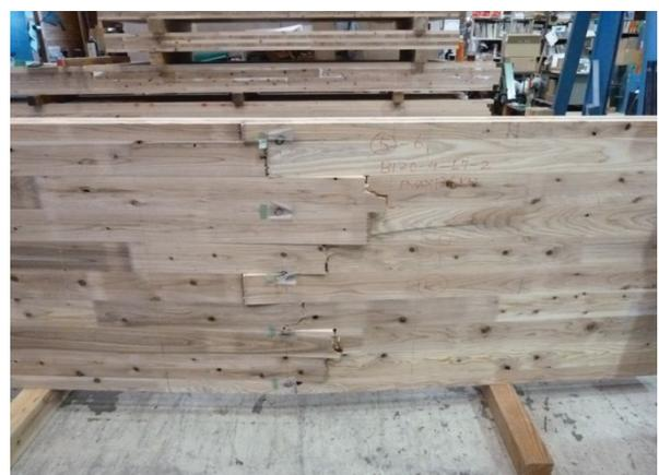
Fig. 3.3.14 厚さ 120mm 4層 最外層ラミナ L70 引張側破壊状況
