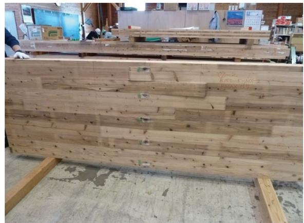
Fig. 3.3.13 厚さ 150mm 5層 ラミナ混合配置 引張側破壊状況
