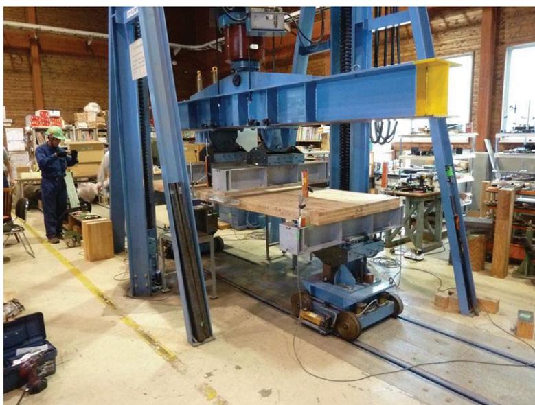
Fig. 3.3.6 曲げ試験装置への試験体設置
