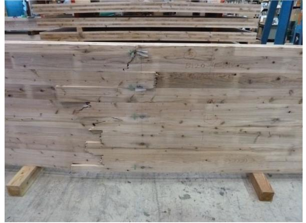
Fig. 3.3.15 厚さ 120mm 4層 ラミナ混合配置 引張側破壊状況
