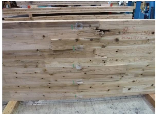
Fig. 3.3.16 厚さ 120mm 5層 最外層ラミナ L70 引張側破壊状況
