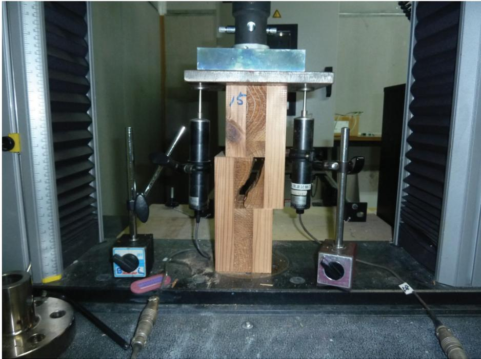
Fig. 4.1.8 ローリングシアー破壊状況
