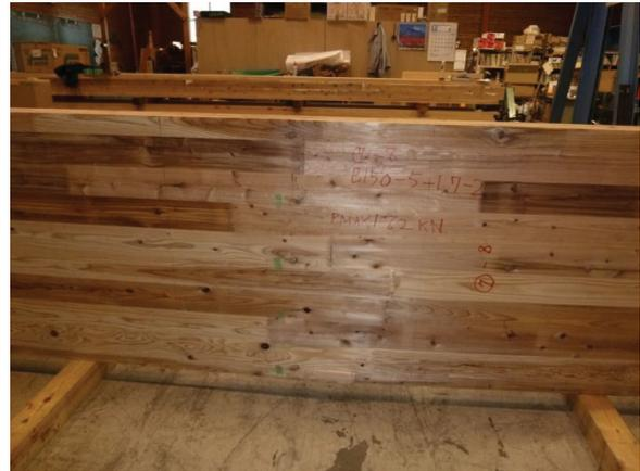
Fig. 3.3.12 厚さ 150mm 5層 最外層ラミナ L70 引張側破壊状況
