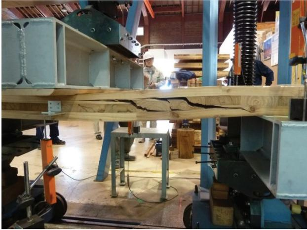
Fig. 4.2.8 厚さ 90mm 3層 ラミナ混合配置 破壊状況
