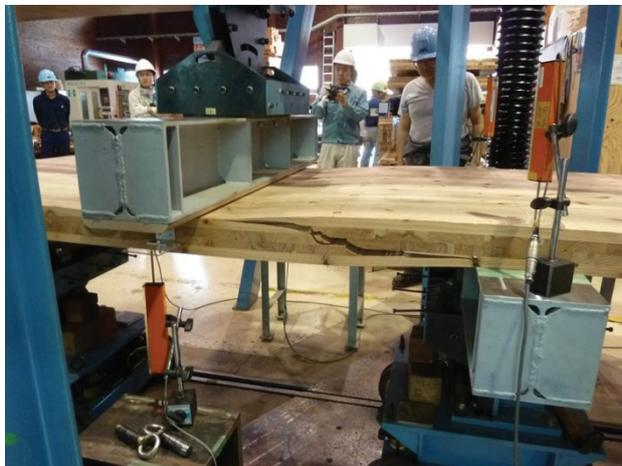
Fig. 4.2.9 厚さ 90mm 4層 ラミナ混合配置 破壊状況
