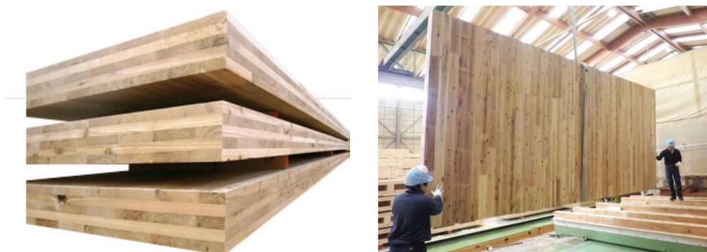
Fig. 1.2.1 スギを用いた CLT パネル
