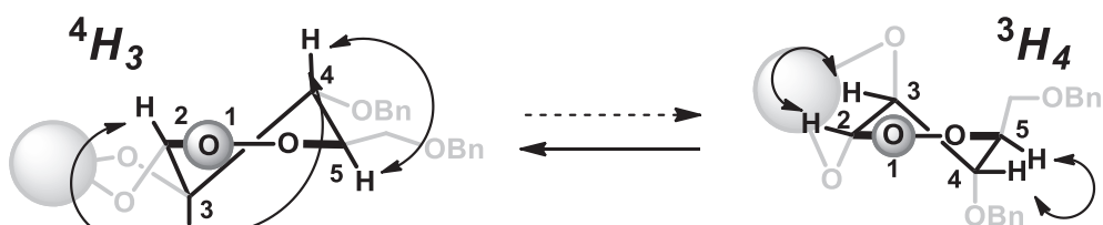
Fig. 9 -80 °C における \sigma -Xylylene 型ラクトン体の配座
