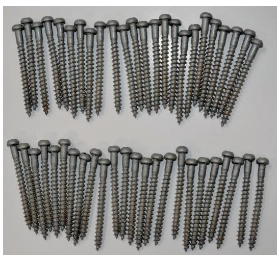
ビス 24 本の破壊（鋼板厚さ 4.5 mm）
