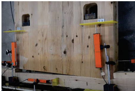
引きボルト型接合部の破壊（引きボルトの伸び）
