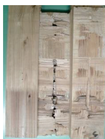
外層・内層ラミナの接着面せん断破壊
