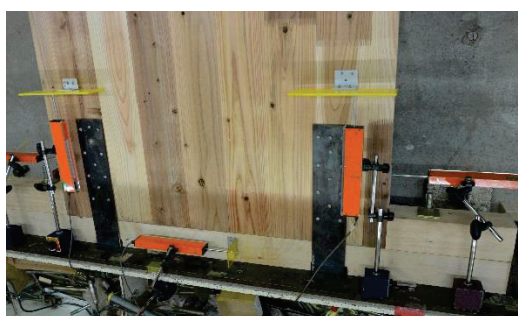
ビス止め接合型（24本 金物厚さ 4.5 mm）の破壊（金物の座屈）
