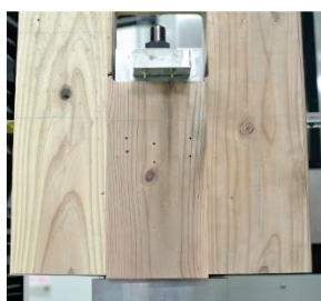
外層・内層ラミナの接着面せん断破壊
