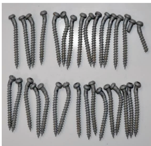
ビス 16 本の破壊（鋼板厚さ 4.5 mm）
