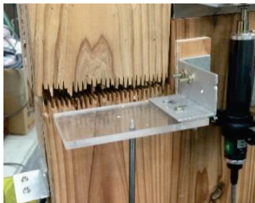
(c).開口部の周りにおける フィンガージョイント破壊 (CLT-P)
