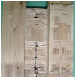
(a).外層・内層ラミナの接着面 せん断破壊 (CLT-P)
