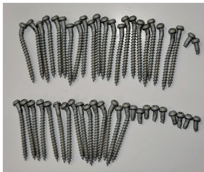
図 4.3.2 ビス止め型接合部の壊性状
