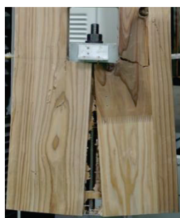
内層ラミナの引張破壊と接着面のせん断破壊
