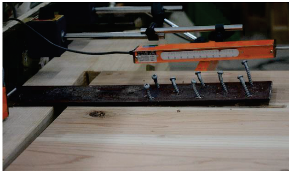
ビス止め接合型（16本 金物厚さ 4.5 mm）の破壊（ビスの引き抜き）
