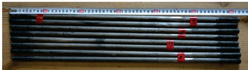
引きボルトの破壊性状
