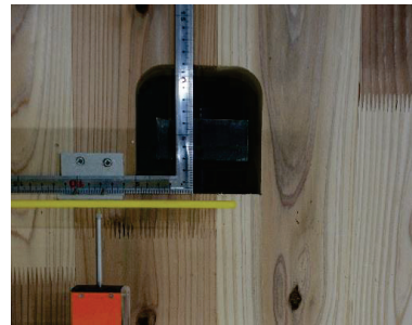
引きボルト型接合部の破壊（引きボルトの伸び）
