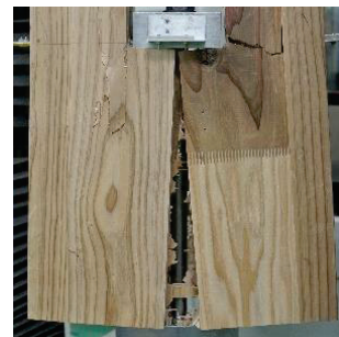
(e).内層ラミナの引張破壊と接着面 のせん断破壊 (CLT-I)
