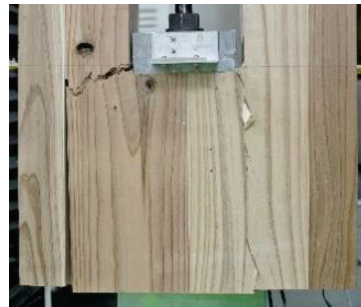
(d).外層・内層ラミナ接着面のせん断破 壊と外層ラミナの引張破壊 (CLT-I)
