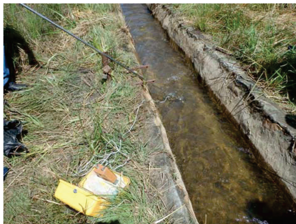
写真 3.12 流量測定状況（取水部）
