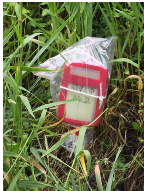
図 4-5 ECHO デジタルロガー（Em50）の設置状況
