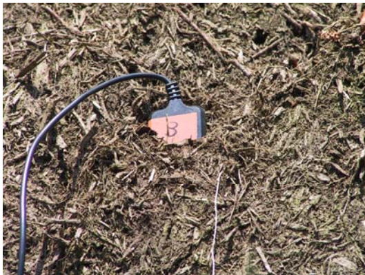
図 4-4 土壌水分センサー（ECHO-10）の 設置状況
