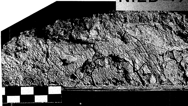
第10図. 第12図Aピース底面に現われた断層条線. 剪断面を野島断層の平均的な姿勢に合わせた場合, 地震断層の地表変位(右横ずれ逆断層運動)と調和的な運動方向を示している.
