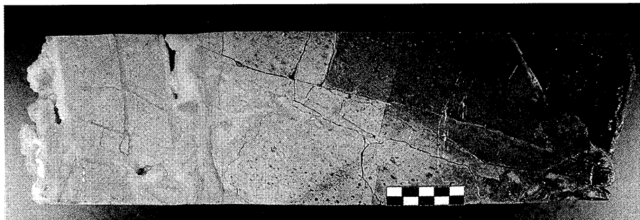
第15図. 中軸帯の下盤側に小規模に現れた有色鉱物の弱い定向配列を伴う葉片状カタクレーサイト. 中角度の剪断面によって弱変形変質花崗閃緑岩と接している. NIEDコア掘削深度1158.01~1158.06m.
