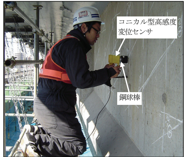
写真-9 弾性波の入力および受振状況
