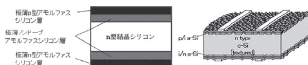
図4 HIT型太陽電池の模式図。N型単結晶シリコンウエーハを10 nm 程度のアモルファスシリコン層でサンドイッチして作製される。効率が高く、現在実用化サイズで23%が達成されている。アモルファスシリコンの効果で、高温でも効率低下が少ないことが特徴である。
