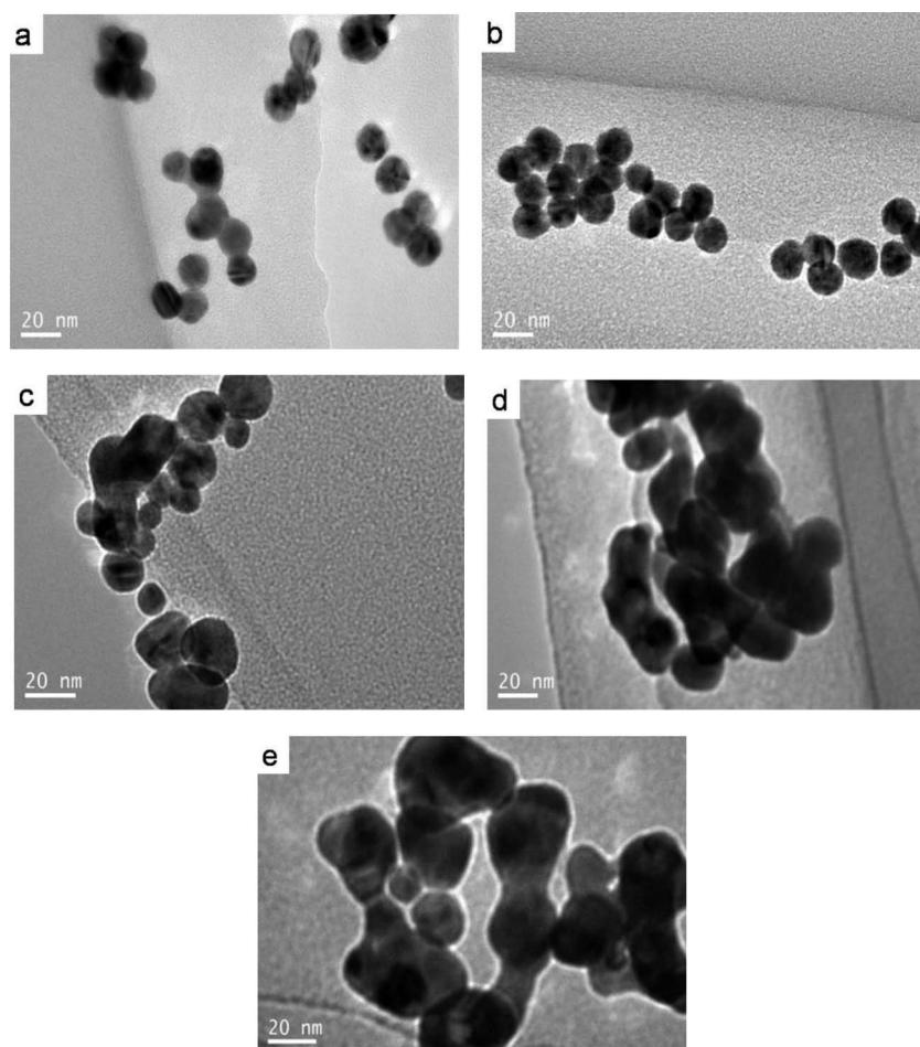
Fig. 3 TEM images of gold nanoparticles: (a) 13, (b) 17, (c) 33, (d) 43, (e) 61 nm.
